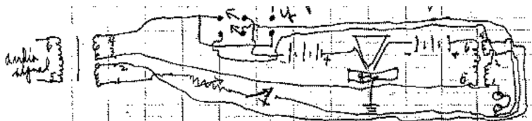
Figura 2: O esquema eléctrico do novo amplificador de áudio realizado com o 1.º transístor.
