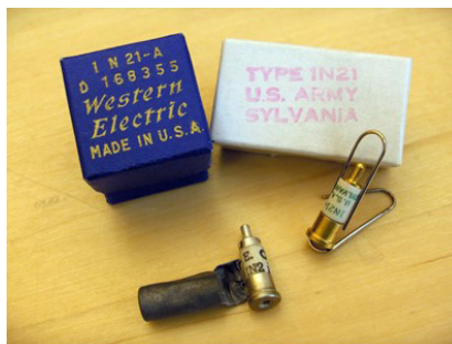
Figura 1: Detetor 1n21 de contacto metálico com germânio.
