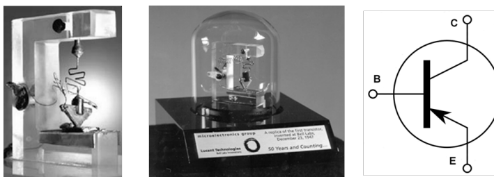
Figura 3: Transístor original, réplica de demonstração e símbolo do transístor.
