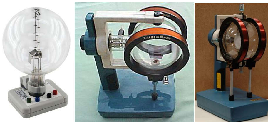
Ampola CRT Limstar (u8481430) e Ampola 3BScientific com bobinas de Helmholtz.
