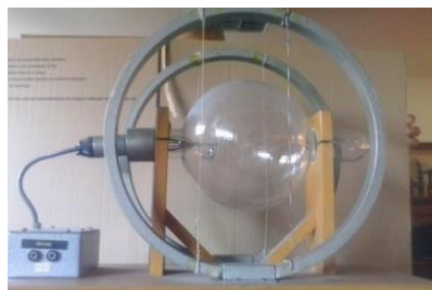
Fig.8: Demonstração: Desvio magnético numa ampola de Wehnelt.
