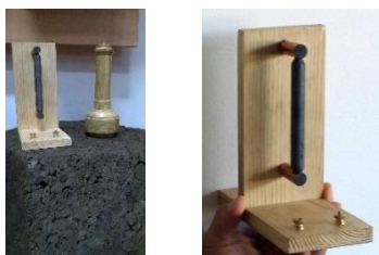
Fig. 5: Réplicas do microfone e do tubo de audição da versão Bell (sala Faraday).
