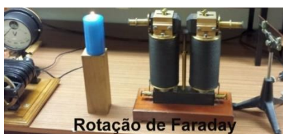
Fig.10: Demonstração: Rotação de Faraday
