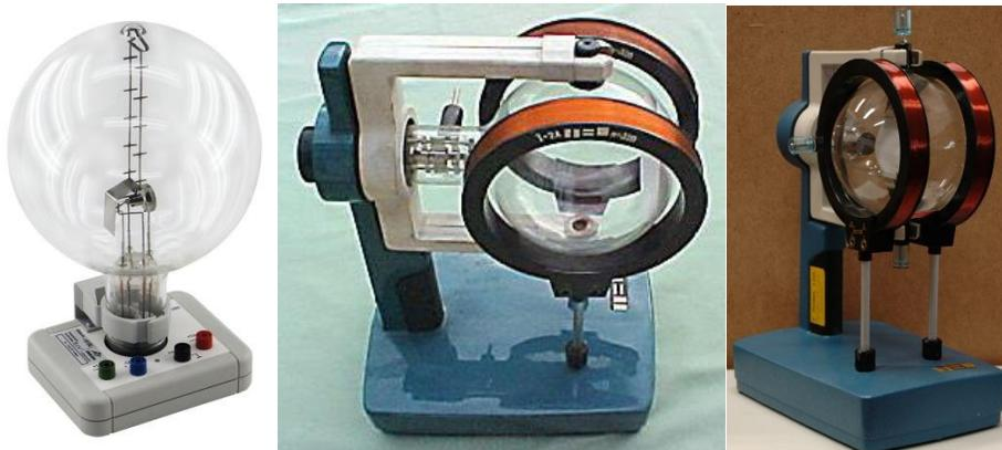
Fig. 1 – Ampola CRT Limstar (u8481430) e Ampola 3BScientific com bobinas de Helmholtz.
