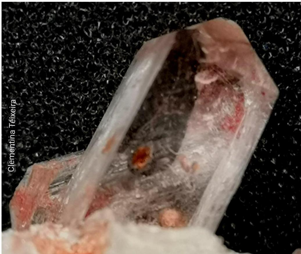
Figura 16 – ADP,  $(\text{NH}_4)\text{H}_2\text{PO}_4$ , amostra da Fig. 15, evidenciando a oclusão do corante na rede cristalina, hábito prisma + pirâmide. Lupa estereoscópica, 10x [20]. Amostra com cerca de 18 anos!
