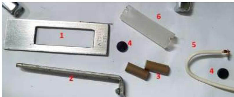
Figura- Partes do isqueiro: 1- Suporte; 2 – alavanca; 3- cilindros de cerâmica piezoelétrica; 4- interface condutora e distribuidora de força; 5- elétrodo com fio isolado a teflon; 6- Invólucro de montagem dos cilindros.
