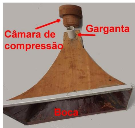
Fig. 17 - Corneta quase pronta e câmara de compressão
