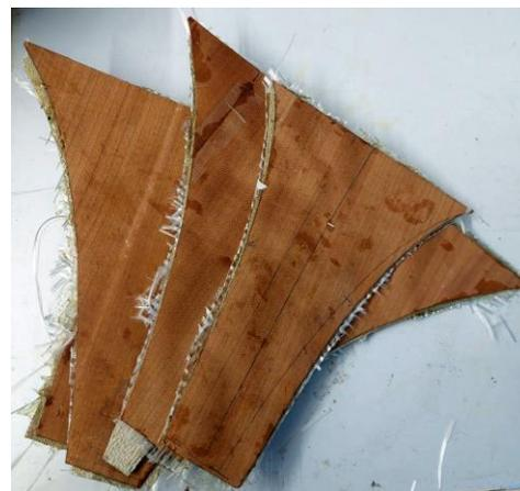
Fig. 15 - Lâminas curvas de madeira compósita.
