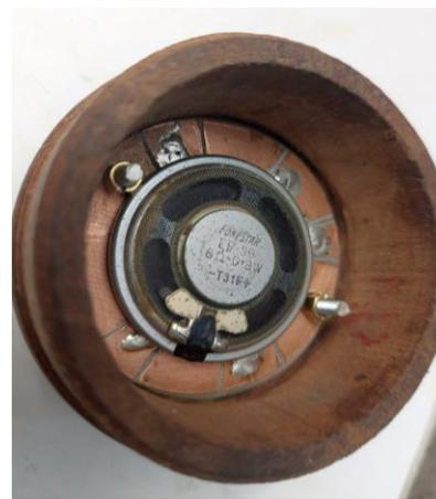
Fig. 9 – Detalhe do suporte da vela grossa. Detalhe de fixação do altifalante e da ligação dos 5 pernos.
