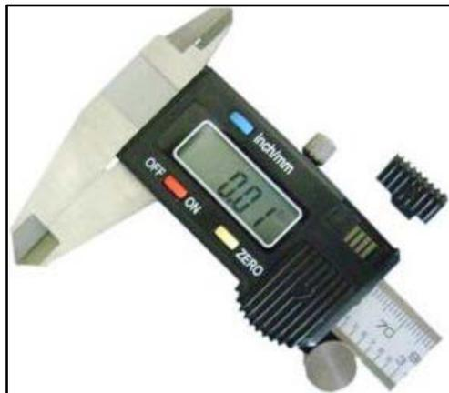
**Figura 5.14** - Paquímetro digital com compartimento dos contactos digitais visíveis [32].
