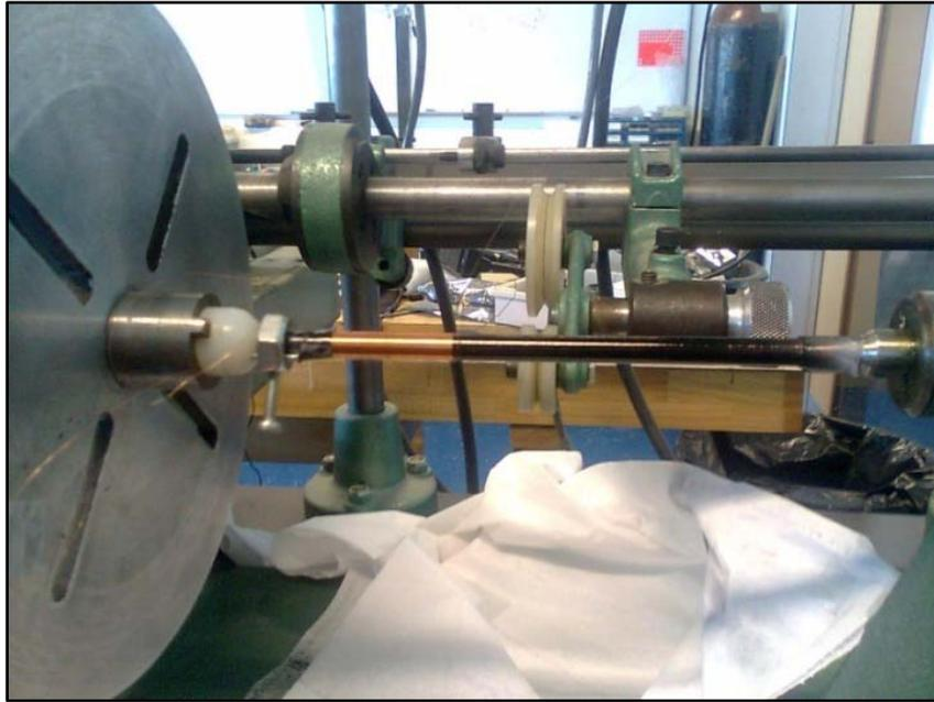
**Figura 5.4** – Transdutor em processo de bobinagem.
