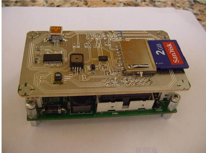
Figura 10.1 - Modo de encaixe entre a placa de circuito impresso do modulo CAN\_PIC FST (baixo) e modulo Banco de Potência (cima)
