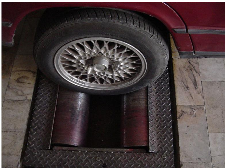
*Figura 5.3.1 - Ponto de contacto entre o veículo e o dinamómetro*
