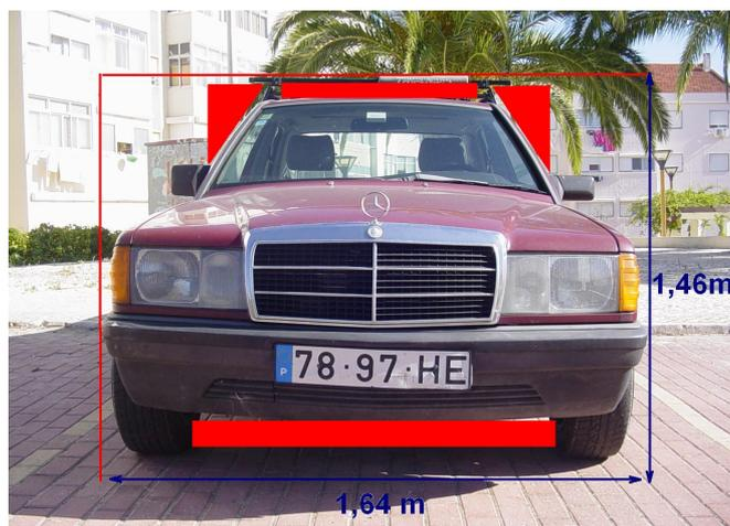
Figura 5.4.1 - Área frontal do veículo de testes
