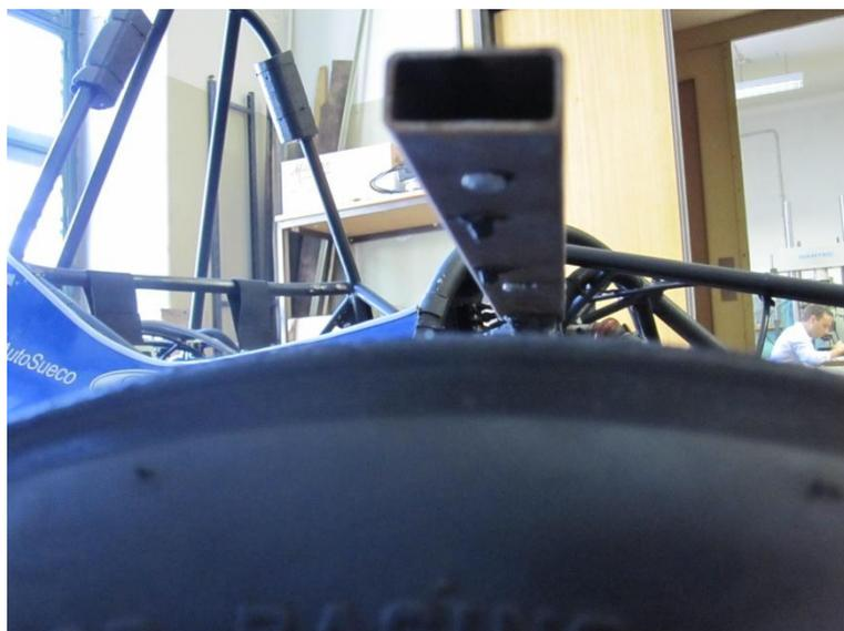
**Figura 50** – Apoio dianteiro dos sensores de temperatura da superfície dos pneus.
