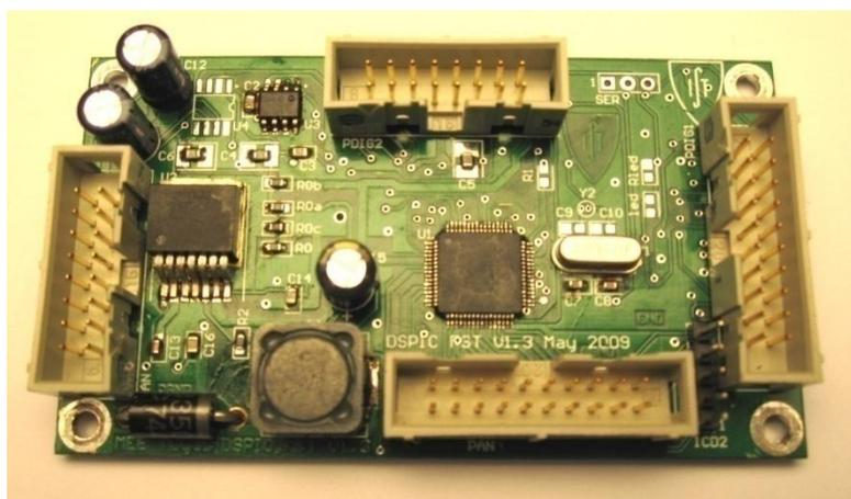
Figura 14 – Módulo de aquisição e processamento de sinais.
