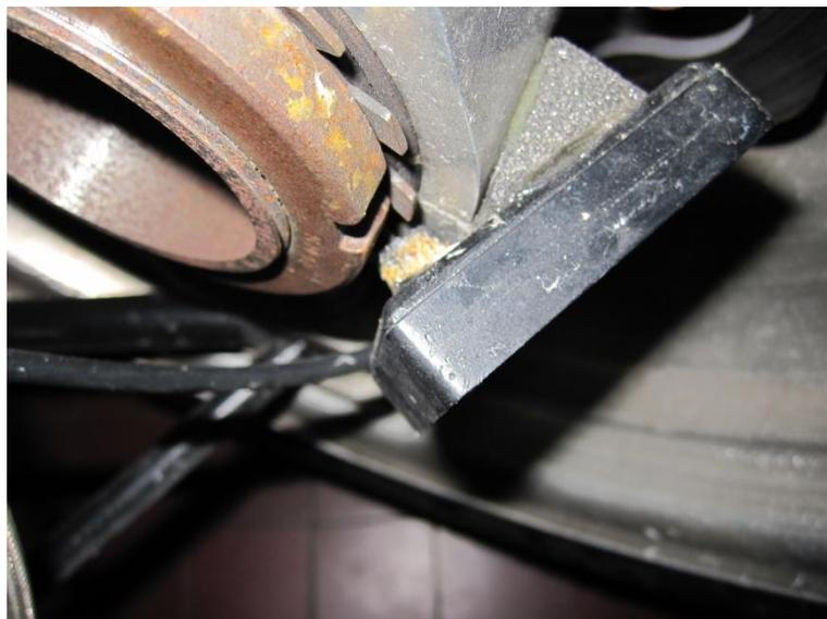
Figura 47 – Montagem do sensor de efeito de Hall no FST-03.
