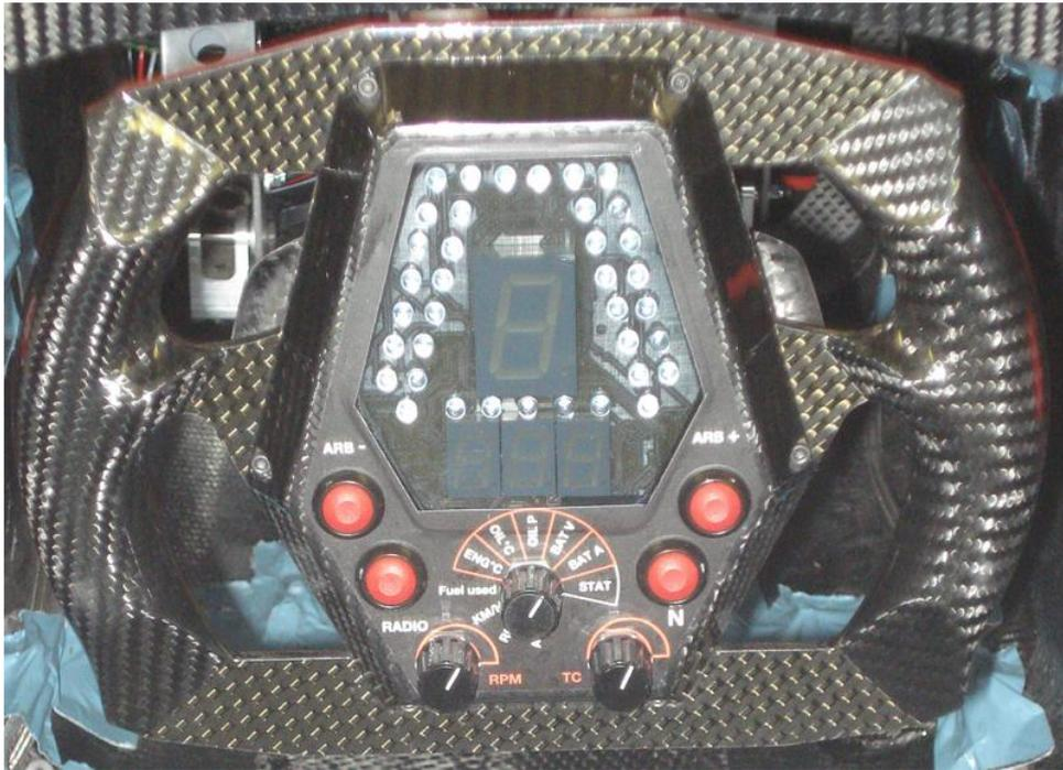
Figura 3 – Volante do protótipo de 2009 da Universidade de Zwickau.
