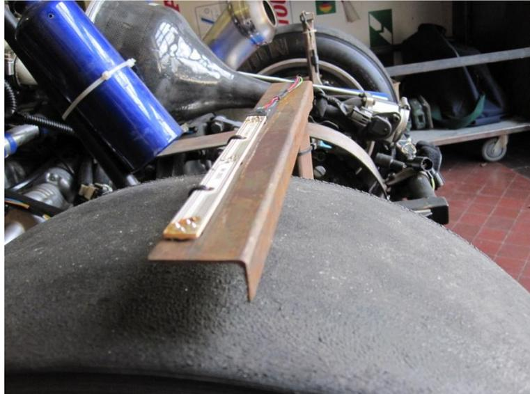
**Figura 51** – Apoio traseiro e PCI dos sensores de temperatura da superfície dos pneus.
