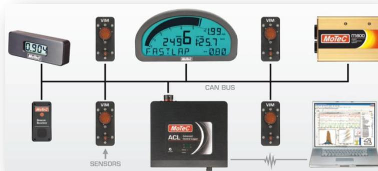
Figura 4 – Sistema completo de aquisição de dados MoTeC.
