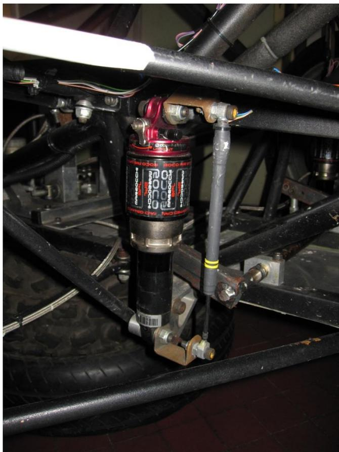
Figura 48 - LVDT montado no amortecedor do FST-03.
