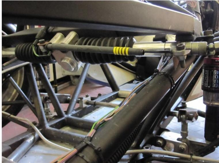
**Figura 49** – LVDT montado na caixa de direcção do FST-03.
