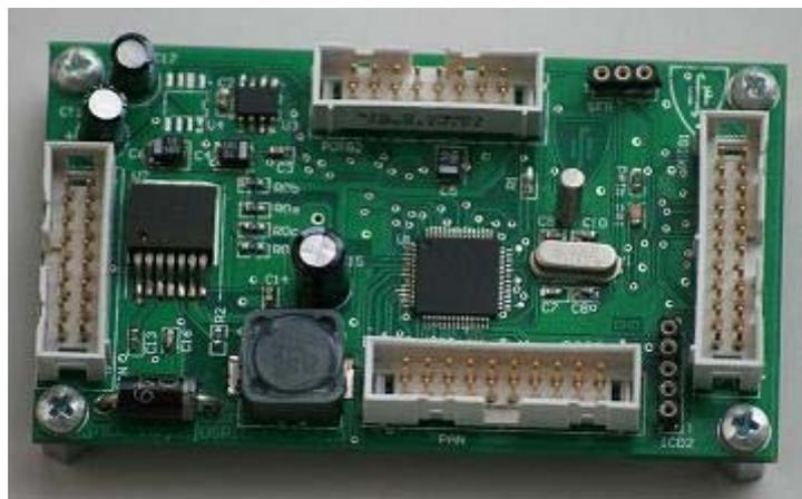
**Figura 10 - Foto Módulo CAN PIC FST.**
