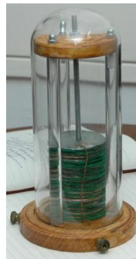
Fig. 1- Pilha de Volta
