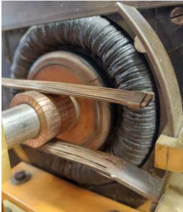
Fig. 12 – Coletor e escovas do dínamo Gramme / Breguet n. 100.
