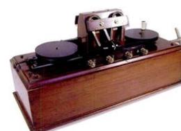
Para receber sinais de rádio modulados havia o detetor de galena e o Prof Fessenden inventou em 1902 um detetor eletrolítico que também convertia sinais AC em DC (retificador) e que patenteou. Um dos primeiros recetores de rádio de Fessenden tinha a arquitetura representada na figura da patente.
