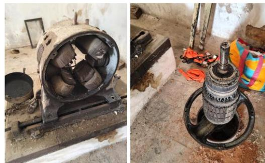
Dinamo - Estator e rotor
