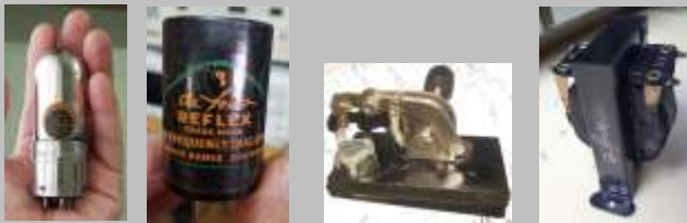
Fig. 3 – Componentes principais do D10 / Main components of D10: Válvula DV2, Transformador de RF, Detetor de galena e Transformador de áudio / DV2 Tube, RF Transformer, Galena detector and Audio transformer.
