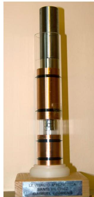
Fig. 2- Levitador magnético com blocos de cobre.
