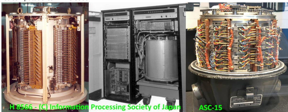
Fig. 9 – Tambor Hitachi H-8566 de 1968 e tambor do computador do foguetão Saturn I de 1961.
