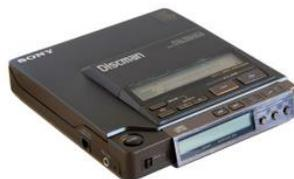
Em 1990 a Sony lançou o modelo Discman D-Z555, onde introduziu técnicas de processamento digital de sinal com processamento de sinal sobre amostrado (8x). Este aparelho ainda hoje é considerado um dos melhores leitores de CDs portáteis e, por isso, é muito procurado
