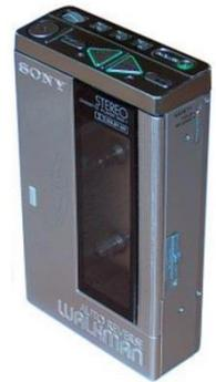
Ainda em 1982 a Sony introduz um dos mais complexos *walkmans* – WM-7, dotado de controlo lógico, 3 motores (um só para a tração da fita). Tem mecanismo de *autoreverse* e sistema de redução de ruído Dolby B, além de embraiagens eletromagnéticas usadas para vários fins.
