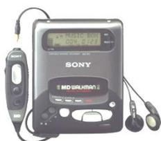
Em dezembro de 1993 a Sony lança o *walkman MiniDisc* MZ-R2, mais compacto do que o MZ-R1 e com memória antichoque de 10 s, dotado também de controlo remoto por fio e auscultadores. Usa o algoritmo de compressão ATRACII. Trabalha com uma bateria de iões de lítio<sup>4</sup> interna amovível a que se pode acrescentar três células AA num adaptador externo; cada destas baterias acrescenta cerca de 3 horas de uso contínuo do *walkman*.
