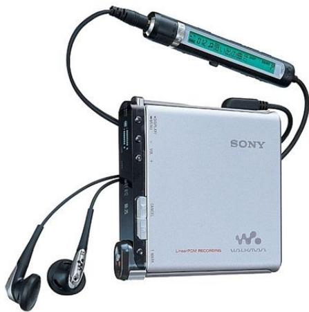
Em junho de 2006 a Sony lançou o modelo MZ-RH1, que é o mais avançado leitor/gravador *MiniDisc* de sempre. Dispõe de visor OLED com toda a informação disponível incluindo indicador de nível e de espectro, dotado de conversores AD e DA dos mais avançados e circuitos de áudio de alta qualidade. Lê e grava em todos os formatos de áudio digital existentes na época.
