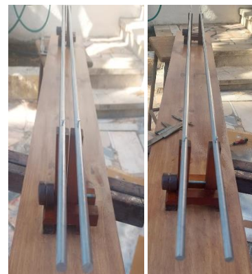
Fig. 5 - Linha configurada com a distância de 25 mm e de 50 mm entre centros dos condutores.
