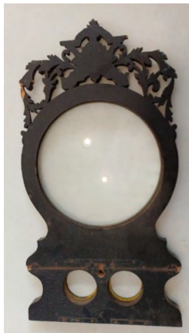
Painel principal de suporte das lentes (vista traseira)
