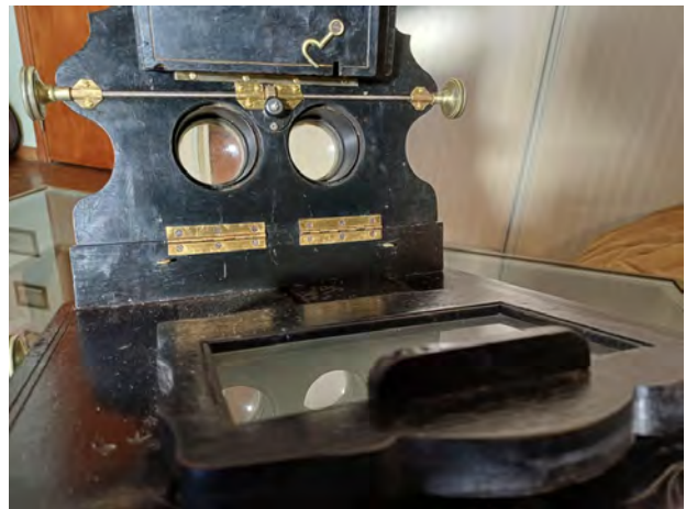
Pormenor do mecanismo de regulação das lentes binoculares após destravamento e recolha da caixa óptica
