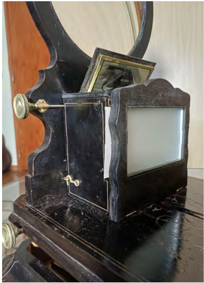
Pormenor da caixa óptica com regulação do espelho a 45° e cartão estereoscópico introduzido.
