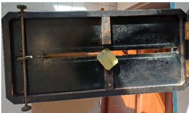
Interior do tabuleiro do dispositivo (vista do mecanismo de translação equipado com roldanas nos topos para tracção do painel de topo por correia de cabedal)
