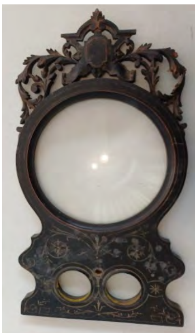
Painel principal de suporte das lentes (vista frontal)
