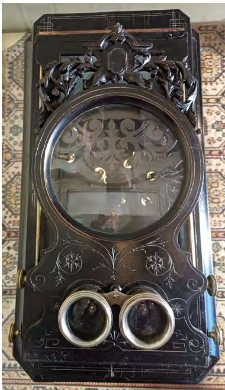
Passo 6 do processo de desmontagem << painel principal e respectiva caixa óptica rebatidos >>
