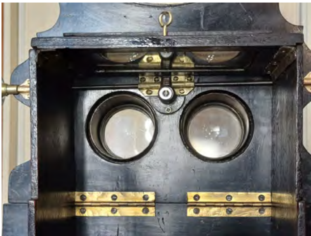
Pormenor do interior da caixa óptica após abertura do painel de suporte dos cartões estereoscópicos
