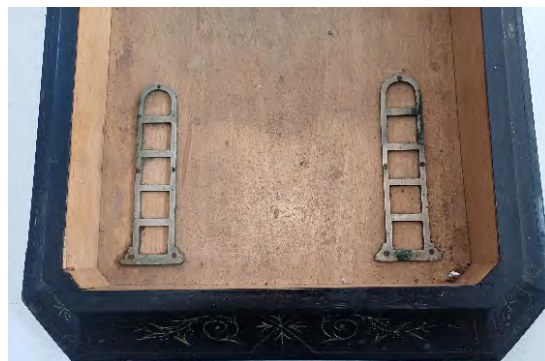
Interior da base do tabuleiro do dispositivo (vista dos apoios do painel de suporte da regulação da inclinação)
