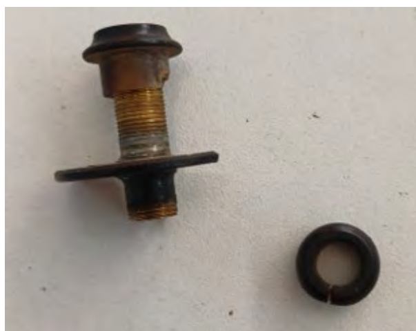
Tubo de cobre de passagem do veio de regulação das lentes binoculares e fixação da engrenagem
