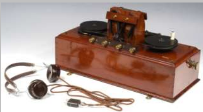
Fig. 2 – Marconi Magnetic Detector "Maggie" [3].
