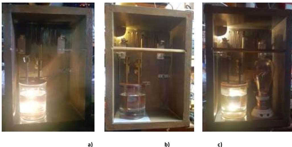
Fig. 9 – Iluminação interna do contador: a) por baixo, b) por cima, c) por baixo e por cima.
