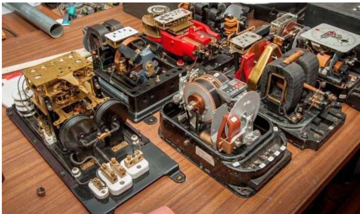
Fig. 4- Museu Faraday: contadores de energia contínua usando o princípio de Ehlui Thomson.
