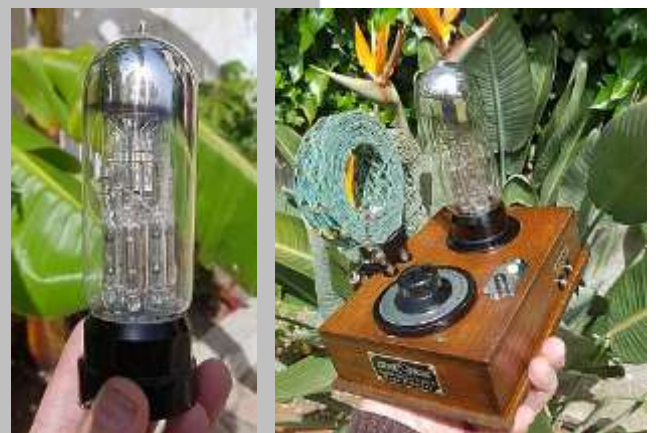
Fig. 2 – The first Integrated Circuit - Tube 3NF, used in Radio OE333 / O primeiro Circuito Integrado - Válvula 3NF, usada no rádio OE333. Museu Faraday
