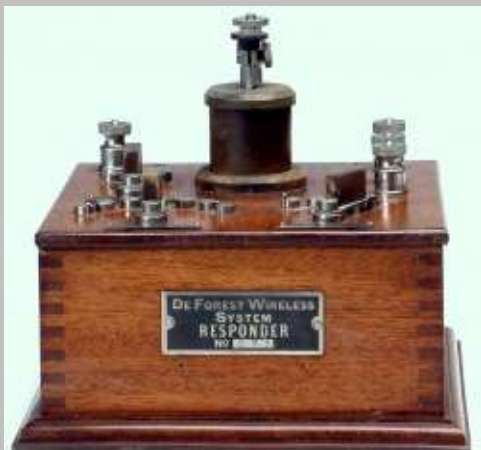
Fig. 2 – Forest detetor eletrolítico ou “Responder” / Forest electrolytic detector or “Responder”.
