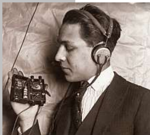
Fig. 1 - USA, June 1921, radio amateur builds miniature radio in a razor blade box / Amador de rádio, constrói rádio miniatura em caixa de lâminas de barbear.
