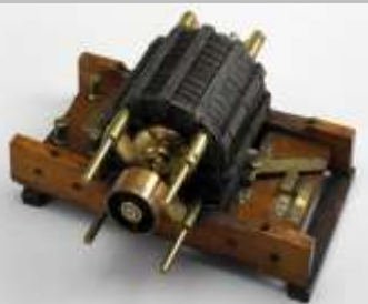
Tesla motor without commutator / Motor de Tesla sem comutador London Science Museum See how it works Veja como funciona
