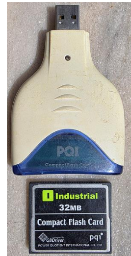
Fig. 16 - Adaptador CompactFlash USB
