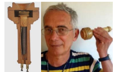
Fig. 7 - Recetor de Bell em corte; utilizador original e réplica do recetor.
