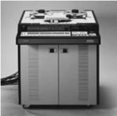
Fig. 14.6. Sony PCM-3324 DASH format 24-channel DAT (5)
