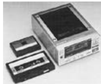
Fig. 14.9. Sony R-DAT prototype (1982) (9)
